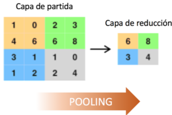
Figura 3.4: Esquema del funcionamiento de la Capa de Reducción de una CNN
