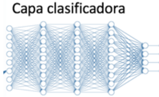
Figura 3.5: Esquema Capa Clasificadora de una CNN
