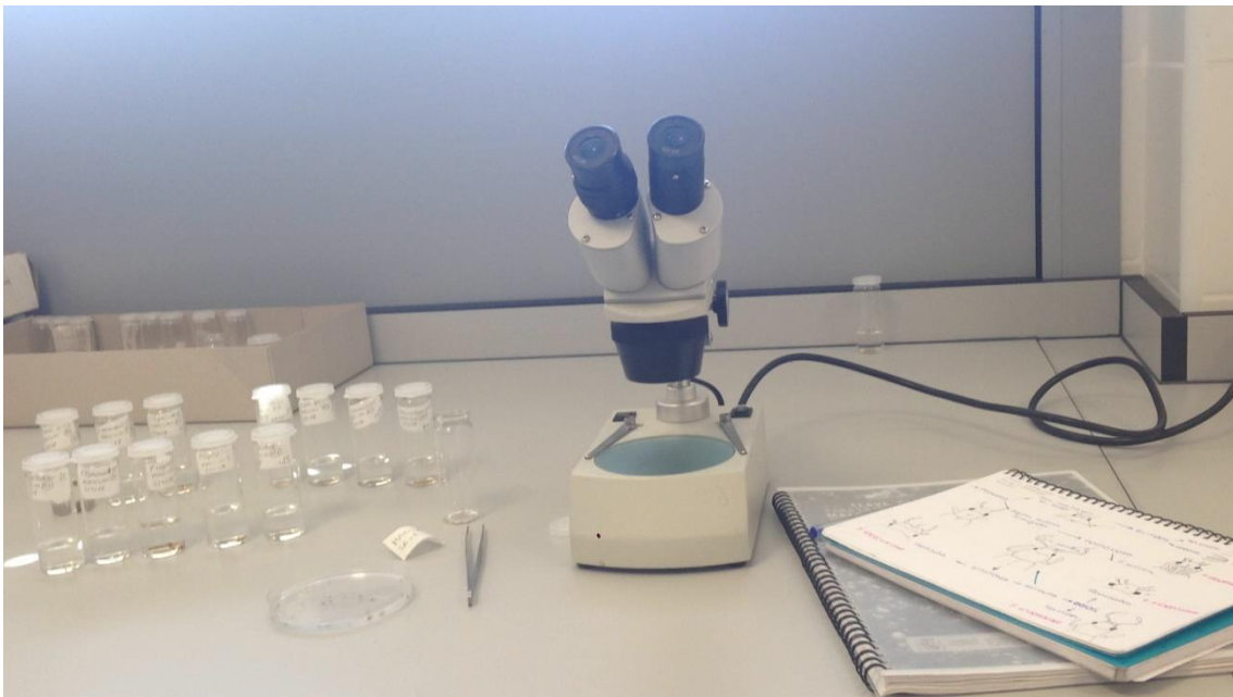
Figura 5: Laboratorio en el que se analizan las muestras de macroinvertebrados con la lupa estereoscópica, las guías de identificación, una pinza entomológica, una placa Petri y los viales de vidrio bien etiquetados. Fuente: elab. Propia.
