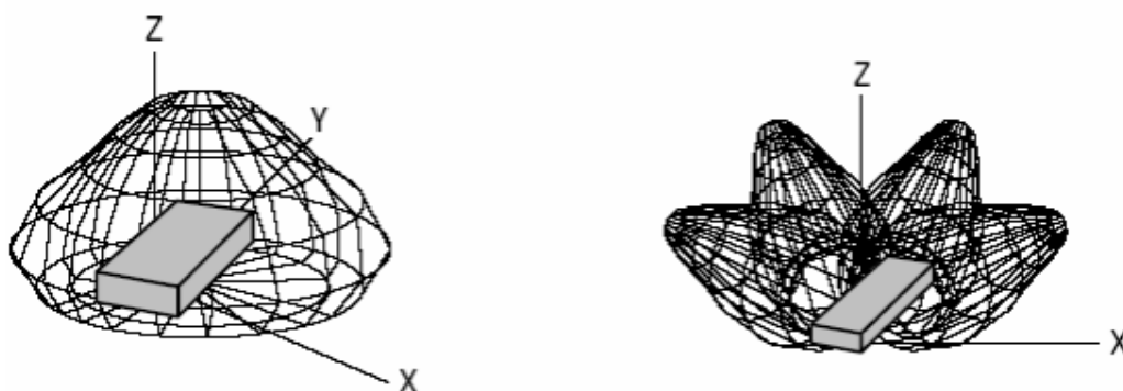
Figura 18: Comparación de los patrones de radiación para una caja de pañuelos (izquierda) y un líquido embotellado (derecha). Fuente: RFIDmagazine.
