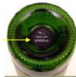
Figura 33: Tag de frecuencia dual colocado en la base de una botella. Fuente: "RFID for the wine industry" [25].
