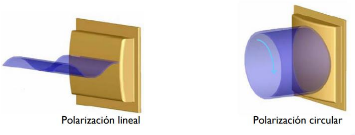
Figura 68: Tipos de polarización. Fuente: RFIDmagazine.
