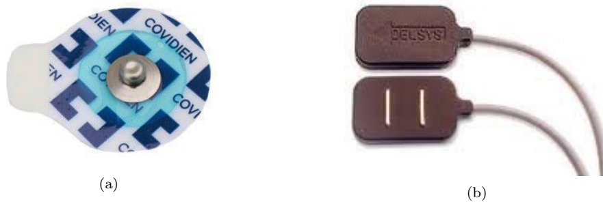
Figura 1.2: Electrodos de superficie pasivos (a) y activos (b)
