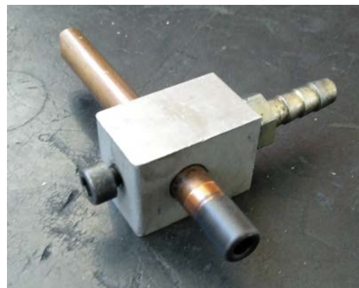
Ilustración 23: Electrodo de limpieza por aspiración utilizado en el primer proceso de mecanizado de BolaAgujero
