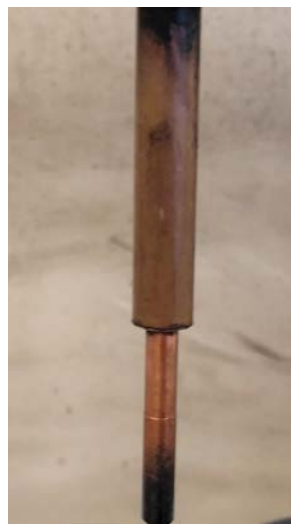
Ilustración 25: Electrodo de limpieza por presión utilizado en el segundo proceso de mecanizado de BolaAgujero
