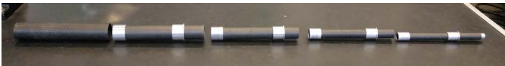
Ilustración 32: Preparación para el montaje del subconjunto Casquillos, Tubos y Adaptador Tridente-tubo pequeño
