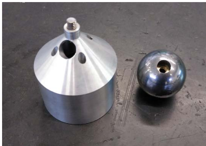
Ilustración 28: Montaje para la unión de BolaAgujero y Conector eje pequeño
