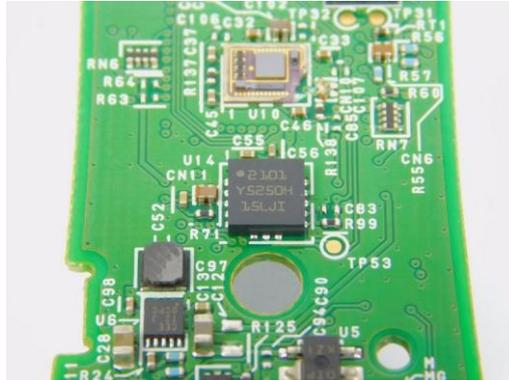
**Figura 2.33** Giroscopio de un eje
