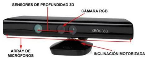
**Figura 2.13** Cámara Kinect Xbox 360
