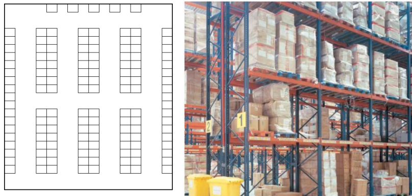
Figura 1: Planta del almacén y estantería (Fuente: Mecalux).
