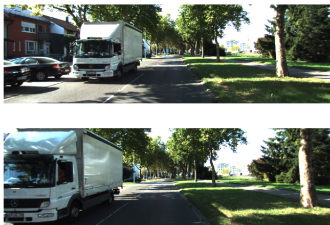
Figura 1.2: Ejemplo de un objeto dinámico que entorpece el proceso de estimación de la posición de la cámara puesto que se mueve en dirección opuesta al resto de elementos. Estas imágenes provienen del dataset de conducción autónoma KITTI [4].
