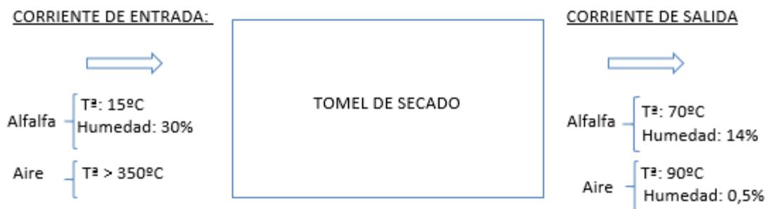
**Figura 4.** Corrientes de entrada y salida en el tromel de secado.
