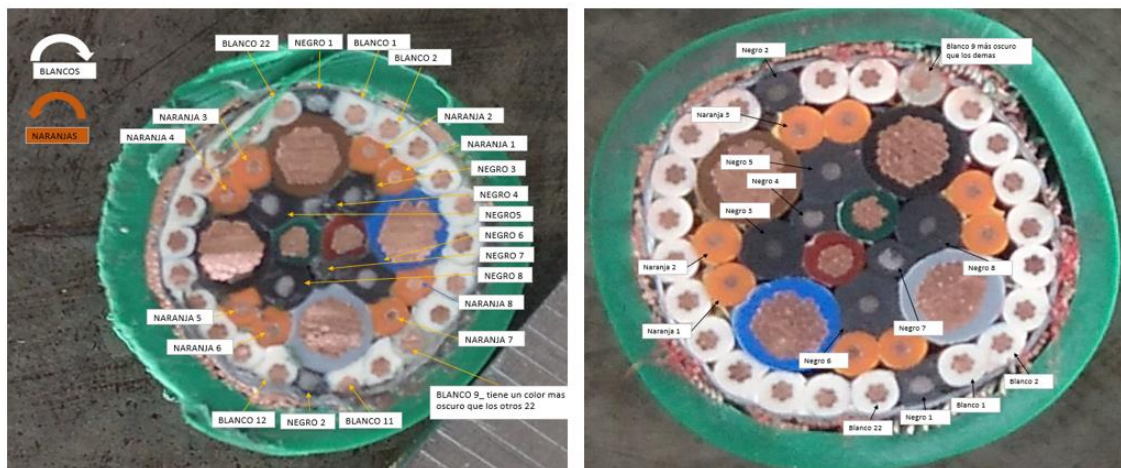
Figura 22: A la izquierda sistema de referencia definido para las medidas y para la generación del modelo, a la derecha el uso del cable 9 para la identificación de todos los demás conductores en una foto de medida de dimensiones geométricas
