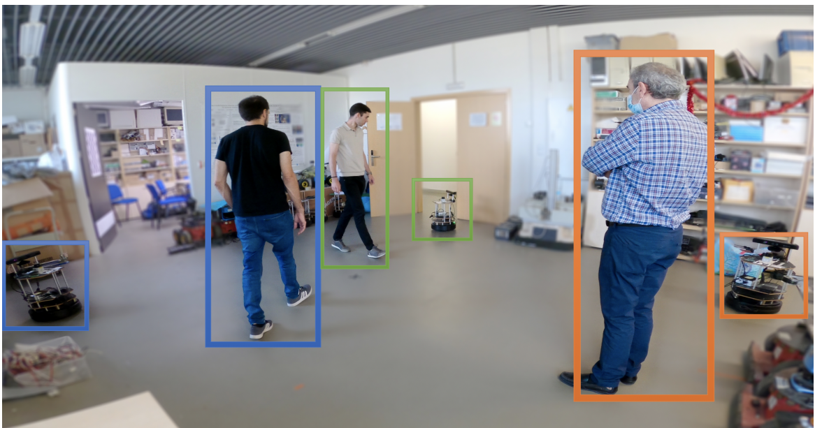
Figura 5.6: Visión del conjunto utilizado para los experimentos en el laboratorio. Se visualizan robots y objetivos utilizados con sus respectivas asignaciones identificada cada una con el mismo color que el robot que los observa.
