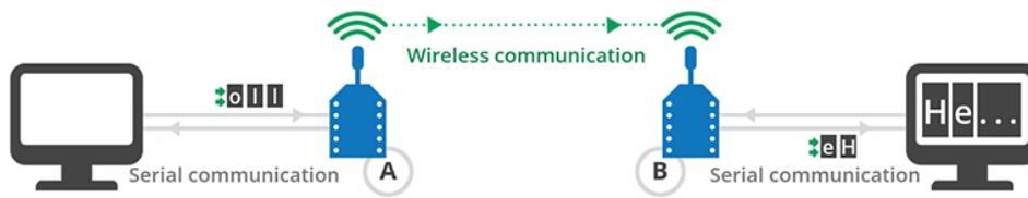
Figura 15: Esquema de comunicación con antenas XBee
