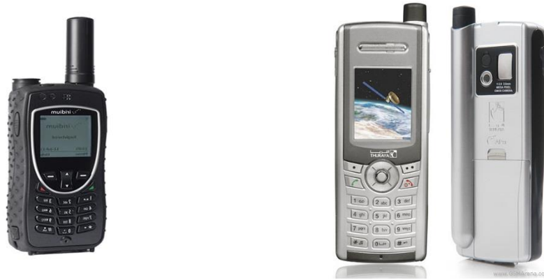
Figura 11: Terminal Iridium (izquierda) y terminal Thuraya (derecha) [11]
