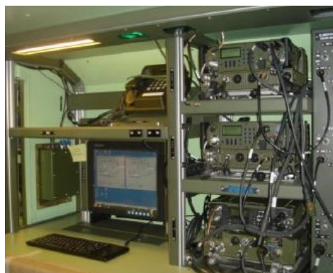
Figura 6: Interior de un vehículo Mercurio, con las 2 radios PR4-G y la radio TRC 3600 [10]
