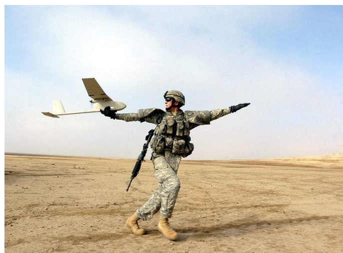
Figura 17: RAVEN lanzado manualmente [23]
