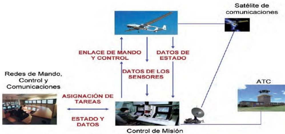
Figura 16: Esquema de comunicación con un UAV [22]
