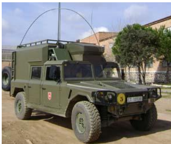
Figura 14: Vehículo "Mercurio" con antena para enlace NVIS [20]
