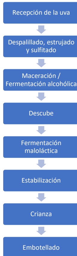
Figura 3: Diagrama de flujo de las principales fases del proceso de elaboración de vino
