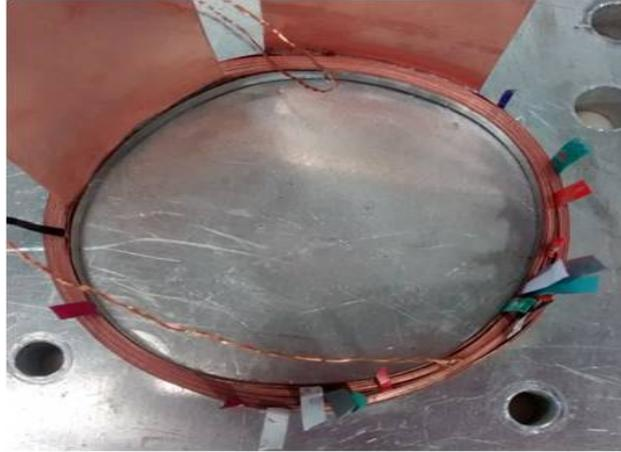
**Figura 2.11.** Fotografía de la bobina 7 (SS20D\_1) co-bobinada con cinta de acero inoxidable. La bobina presenta una ligera forma elíptica ya que se deformó al extraerla del soporte de Teflón.
