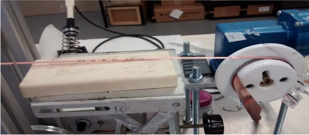
**Figura 2.6.** Fotografía de la plataforma plana utilizada en el sistema de bobinado con el fin de facilitar la colocación de las conexiones para la medida de voltaje y temperatura minimizando los riesgos de dañar el superconductor.
