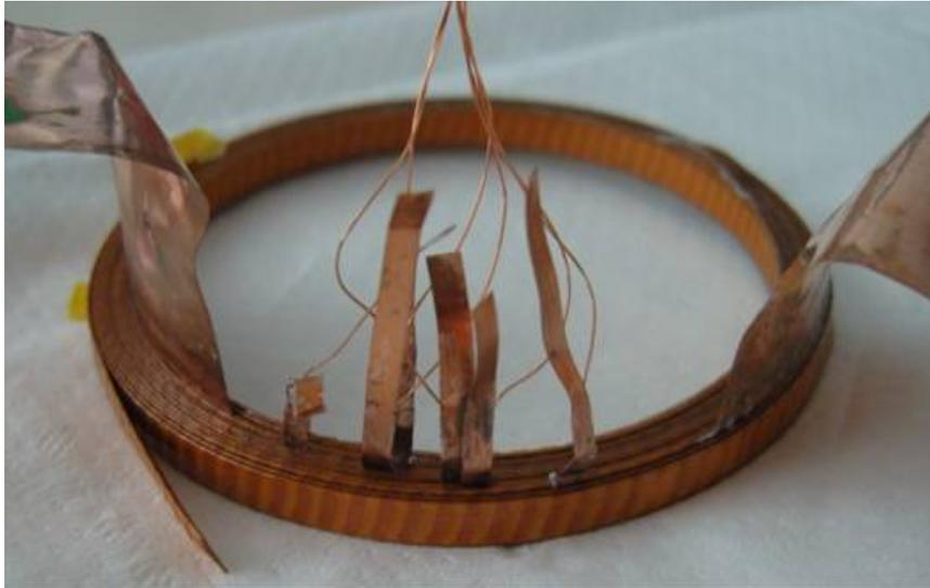
**Figura 2.9.** Bobina 2 (Kh10W\_1) realizada con 10 vueltas de cinta 2G HTS aislada con una capa de Kapton enrollada a su alrededor en forma helicoidal e impregnada vuelta a vuelta con resina epoxi Stycast 1266. Las dos láminas de cobre más anchas al comienzo y al final son para inyectar la corriente y las más estrechas para la medida de voltajes en puntos determinados.
