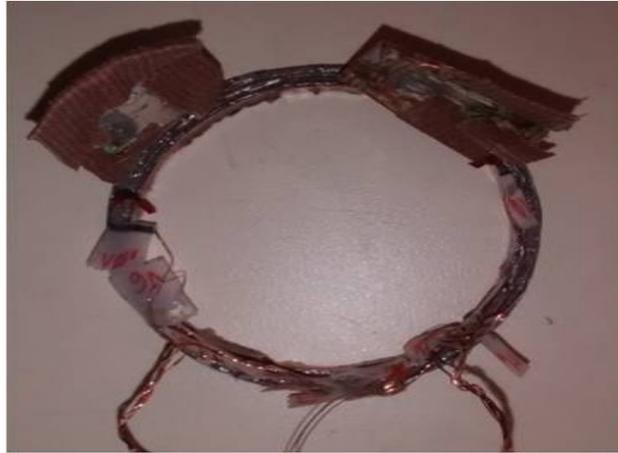
**Figura 2.12.** Fotografía de la bobina 9 (AAI20D\_1) co-bobinada con cinta adhesiva de aluminio anodizado.
