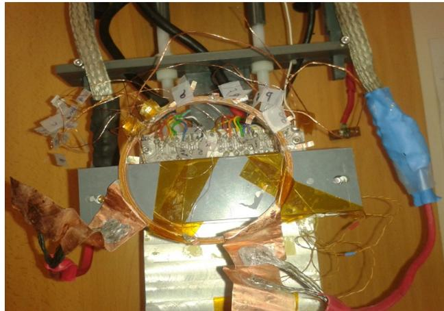
**Figura 2.8.** Bobina 0 (K20W) conectada al soporte en el que se realiza su caracterización inicial a nitrógeno líquido.
