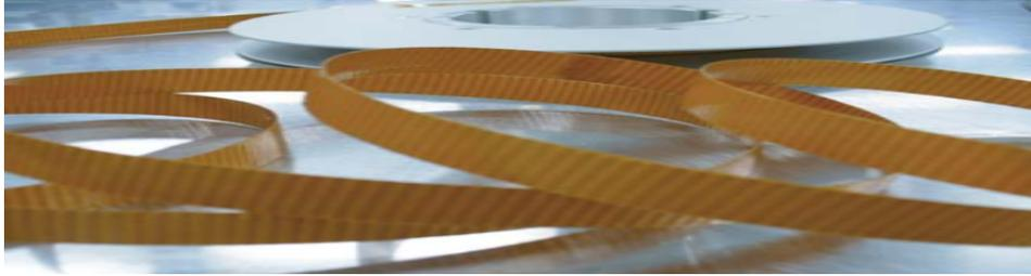
**Figura 2.2.** Cinta 2G-HTS recubierta helicoidalmente con aislante de Kapton con una superposición entre vueltas del 30% [2].
