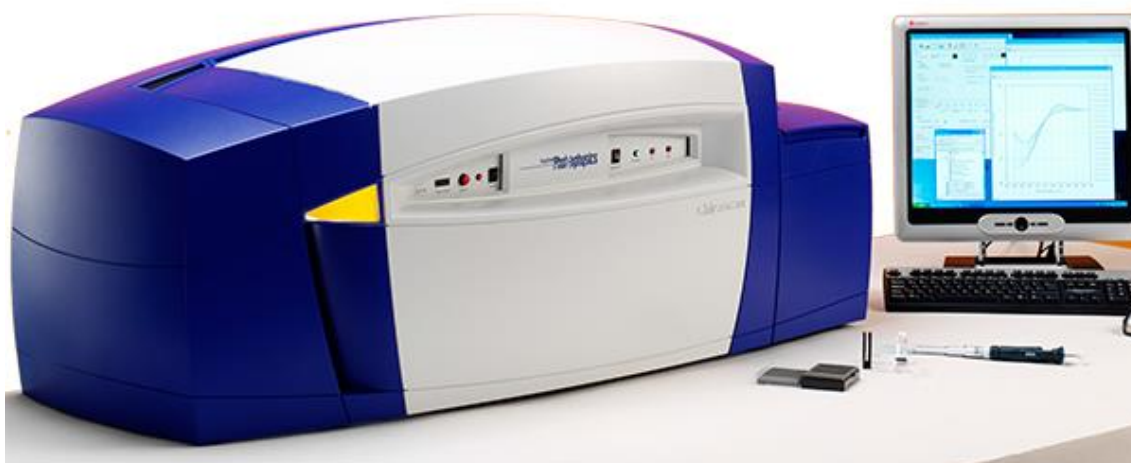
Figura 2.27 Espectrómetro de Chirascan termostatizado (Applied Fotofísica). Fuente: https://www.aimil.com/products/chirascan-cd-spectrometer
