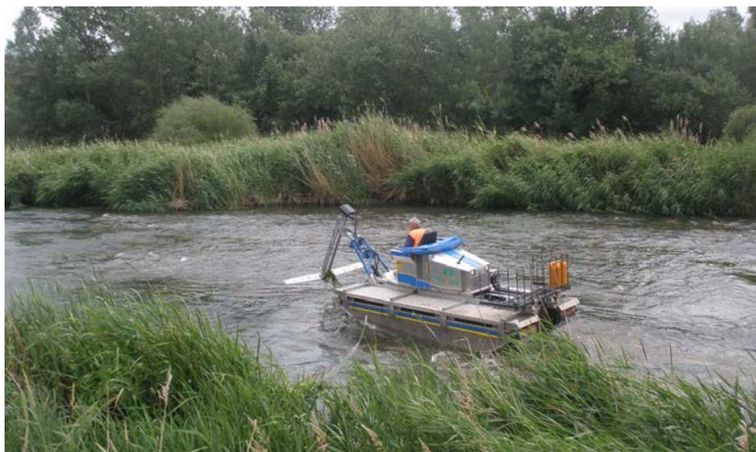
Figura 1.14. Corte de macrófitos con máquina en el río Henares
