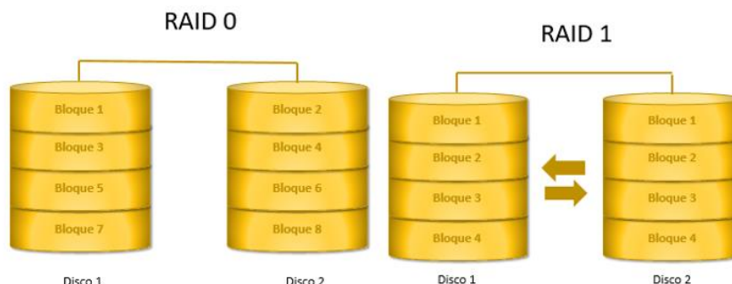
Figura 2.2 Sistemas de archivos RAID 0 y RAID 1. 4
