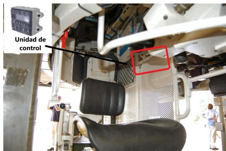
*Figura 17: Colocación de la Unidad de control BTID (imagen del puesto de JC en simulador Leopard 2E)*
