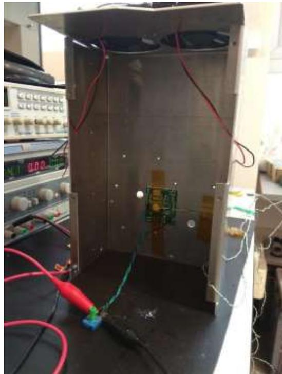
Imagen 18. Ensayo térmico de Silicio en carcasa
