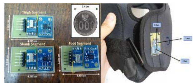
Gambar 5. Kombinasi accelerometer ADXL335 dan gyroscope ENC-03RC pada modul 1, 2, dan 3 (kiri) dan penggunaan 3 sumbu (kanan)
