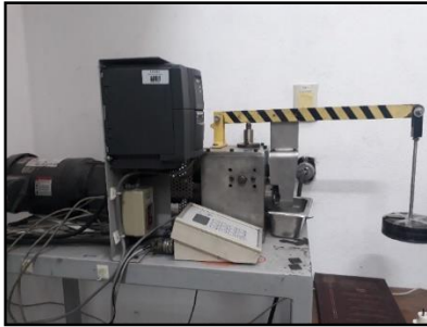
Ilustración 25. Máquina para Ensayos de Desgaste por Deslizamiento con Geometría Block-on-Ring.
