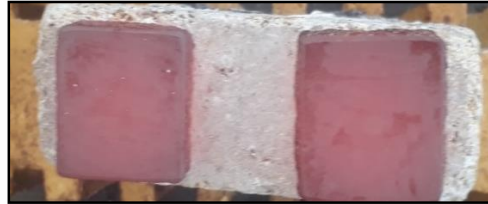
Ilustración 15. Probetas Tratadas Térmicamente Fundición de Cr-V-Mo y Cr-V-Nb.
