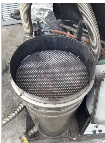
Figura 27: Armado de filtro. Fuente propia.
