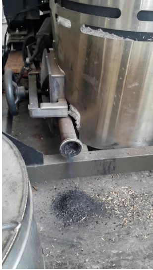
Figura 22: Retiro de material carbonizado. Fuente propia
