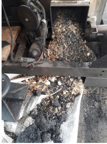
Figura 20: Retiro de material carbonizado. Fuente propia
