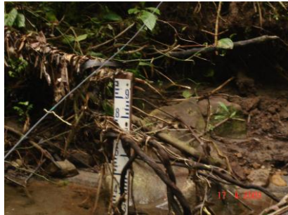
Foto 17. Regla de nivel de agua de la Quebrada Charco Negro
