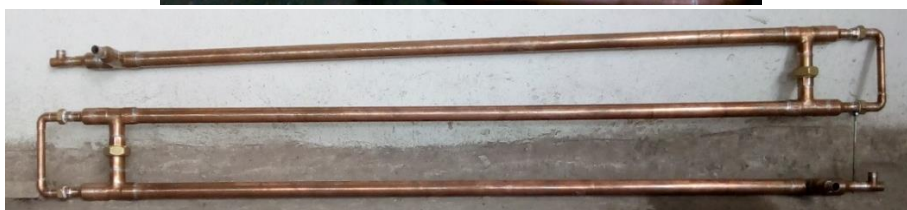
Figura 32. Intercambiador de calor Fuente: elaboración propia.
