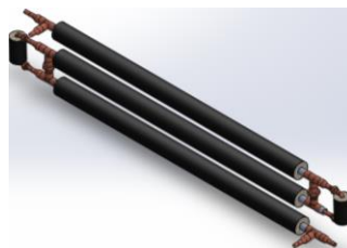
Figura 30. Modelado intercambiador de calor de doble tubo.
