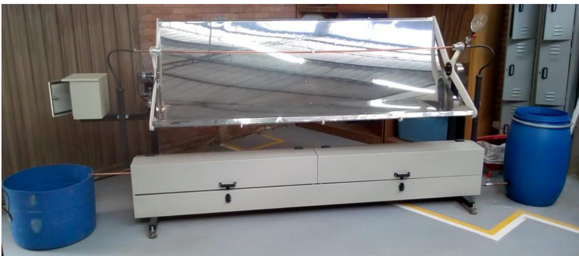
Figura 34. Foto de la construcción de la Integración del CCP más el intercambiador de calor. Fuente: elaboración propia.
