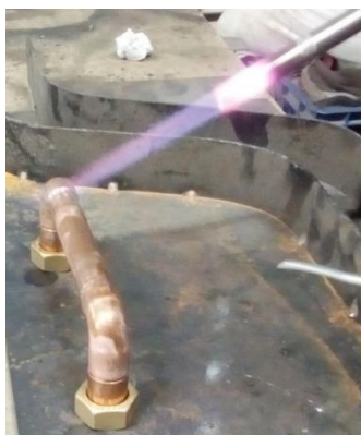
Figura 31. Soldadura blanda de estaño con soplete Fuente: elaboración propia.
