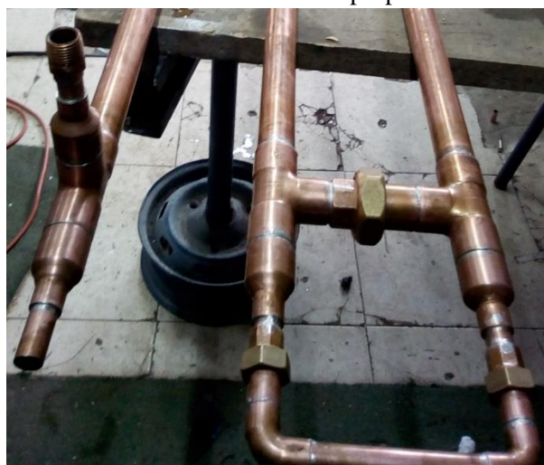
Figura 31. Soldadura blanda de estaño con soplete Fuente: elaboración propia.
