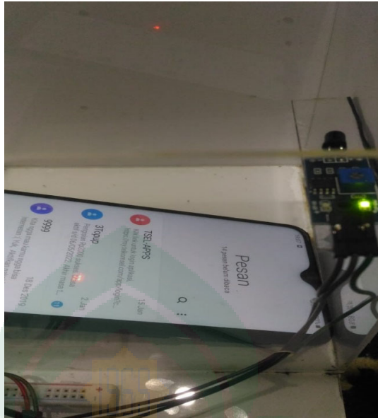
Gambar V.11 Hasil Pengujian Sim900 saat tidak diberikan api pada sensor
