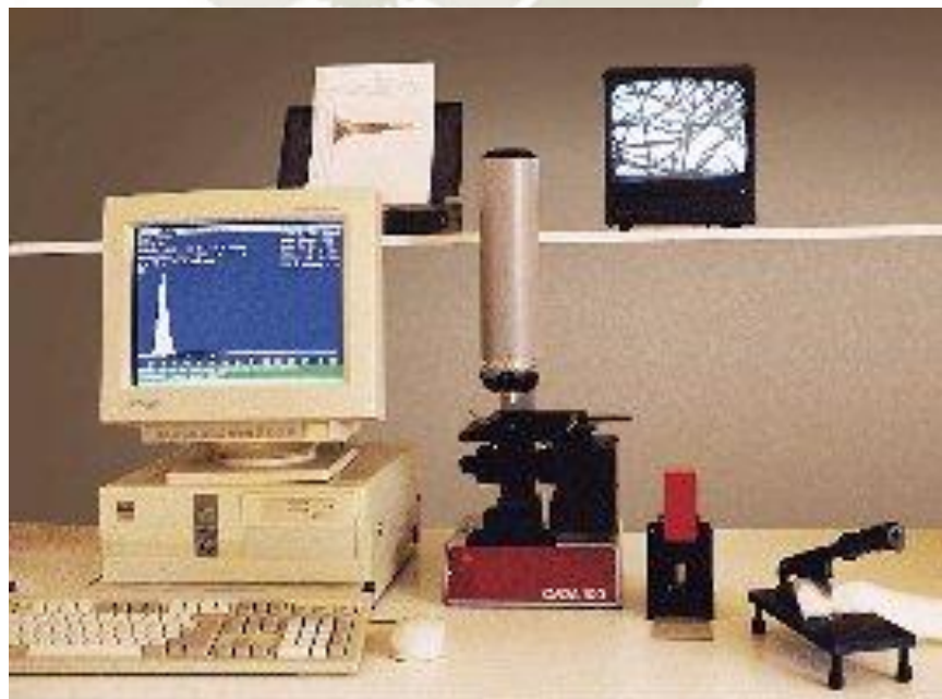
Figura Nro. 4: OFDA 100 (Analizador óptico del diámetro de fibra)
