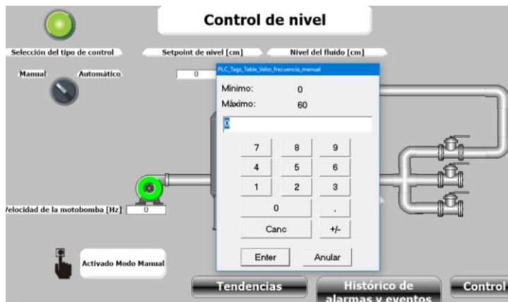
Ilustración 6: Ingreso de la velocidad del motor por pantalla.
