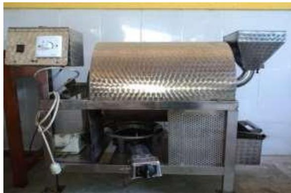
**Gambar 21. Unit Mesin Pengarangan Rotary**
