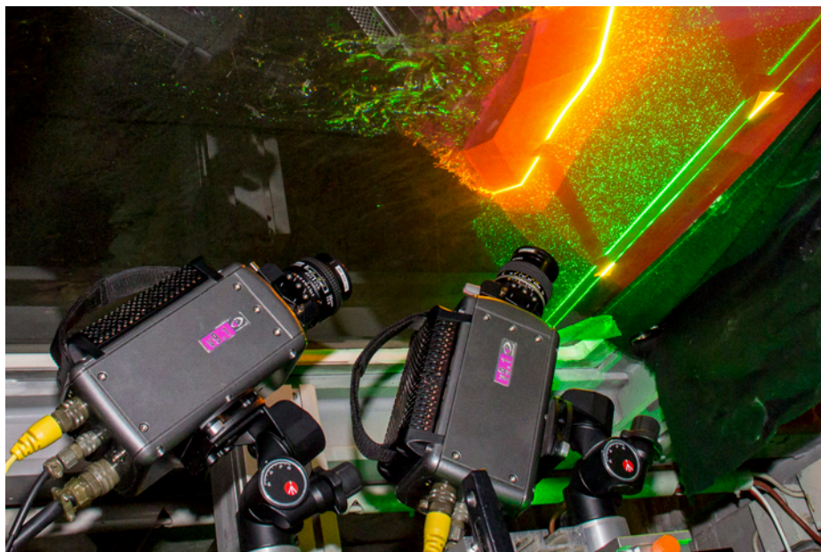
Abb. 2.7: Asymmetrischer Aufbau des PIV-Systems. Beide Kameras befinden sich hinter dem Lichtschnitt. Während die Scheimpflug-Bedingung bei der rechten Kamera nicht erfüllt werden kann, so dass eine optimale Fokussierung nicht möglich ist, leidet das Bild der linken Kamera unter einer erheblichen Stauchung.
