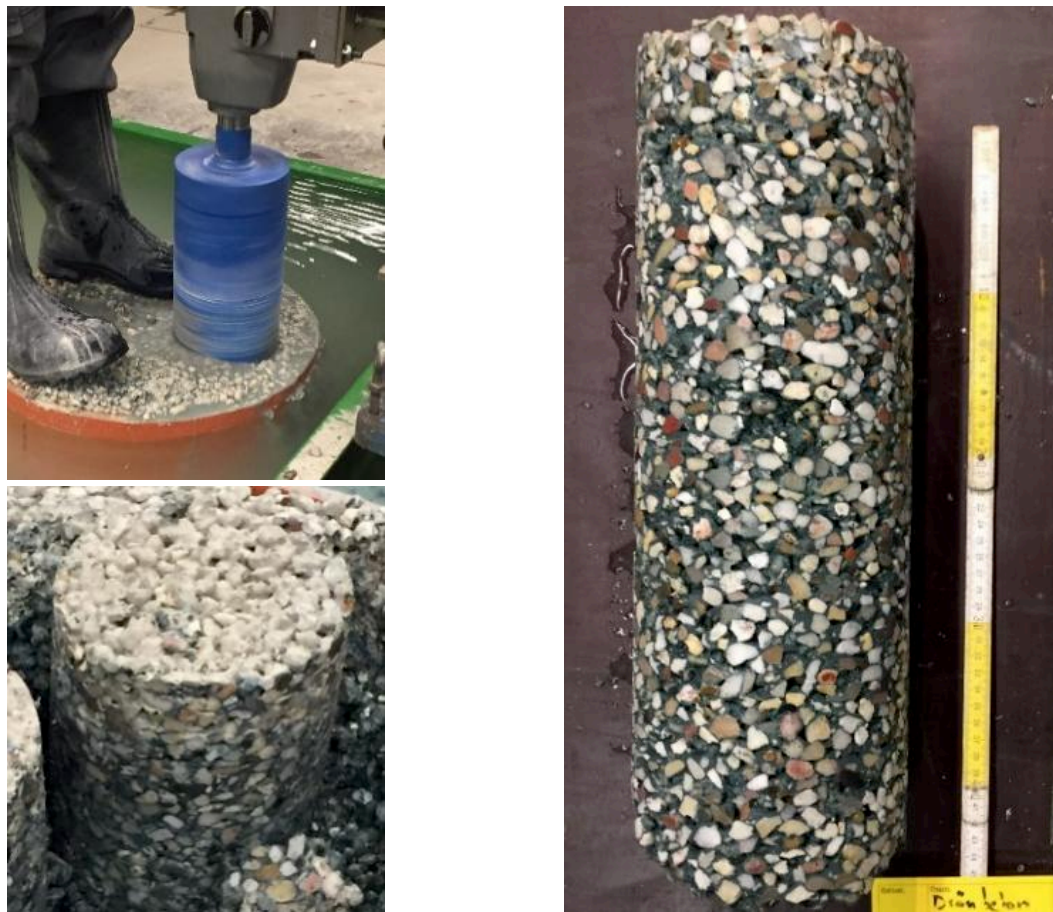
Bild 6: Erfolgreiche Kernbohrung nach 7 Tagen Erhärtungszeit unter Wasser
