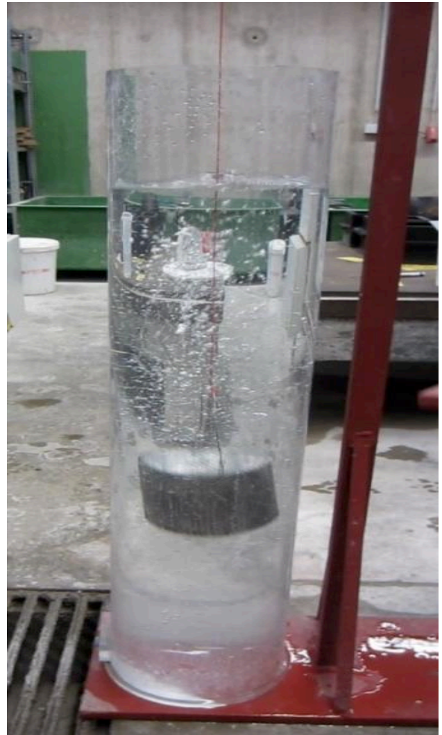
Bild 4: Versuchsaufbau zur Bestimmung des Widerstandes gegen Auswaschung (Abmessungen in mm)
