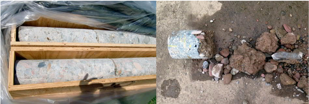
Bild 2: Vergleich von Bohrkernen mit hoher Betongüte (links) und geringer Betongüte (rechts)
