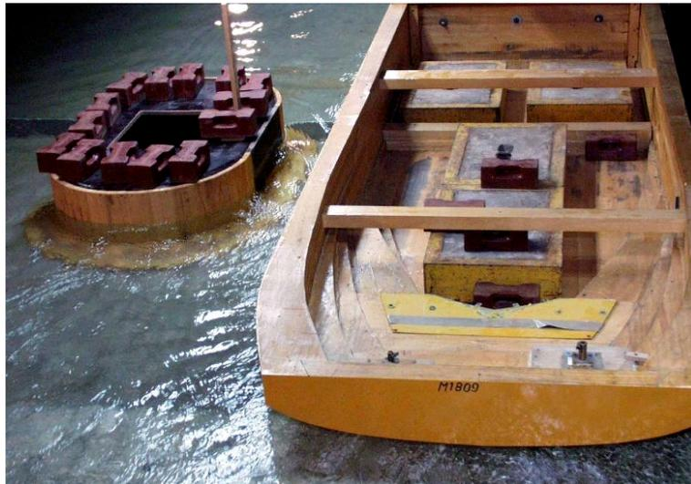
Abb. 2: Binnen-Großcontainerschiff beim Passieren eines Brückenpfeilers in Strömung
