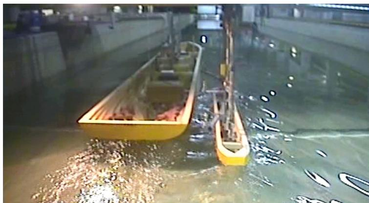
Abb. 4: Extremfall: Jumbo-Containerschiffsmodell (2093 kg) überholt Binnenschiffsmodell (48 kg)
