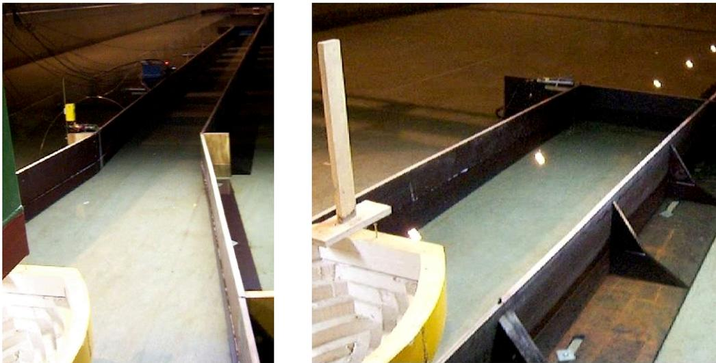
Abb. 7: Gütermotorschiff bei der Einfahrt in die Schleuse
