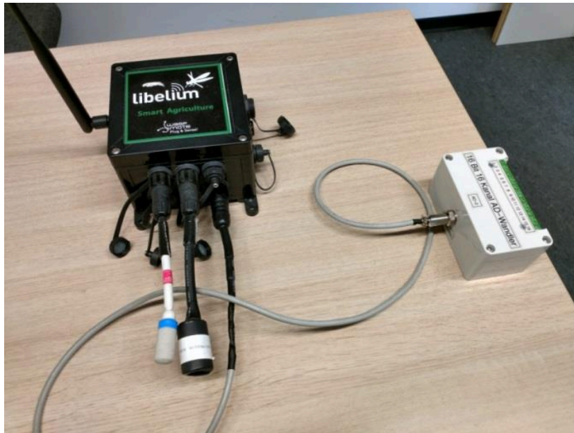
Abbildung 4: Waspote mit angeschlossener A/D-Wandler Box
