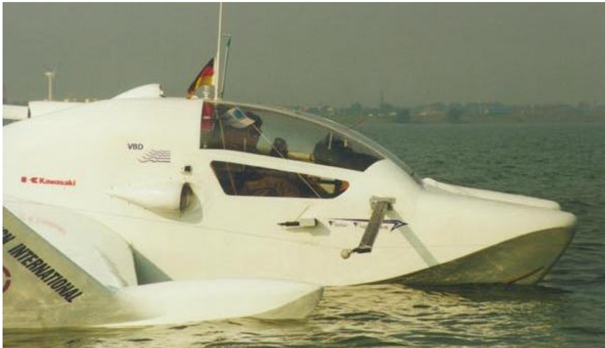
Anbringung einer Videokamera an einer 2-m-Stange seitlich zur Beobachtung des Wasserabrisses an der Gleitstufe beim Start
