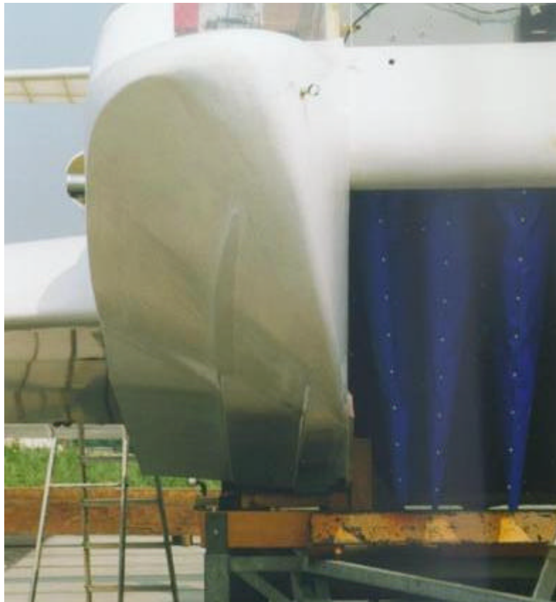
Anordnung der Längsstufen in Frontalansicht
