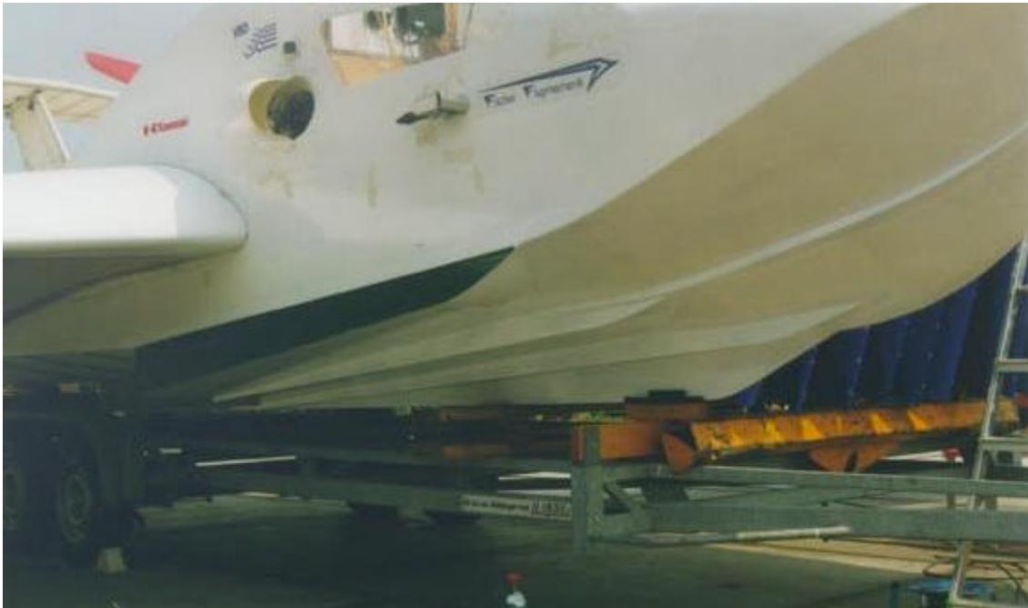
Längsstufenbug mit Abdichtplatte als nachgerüstete Modifikation 1999 Foto 3
