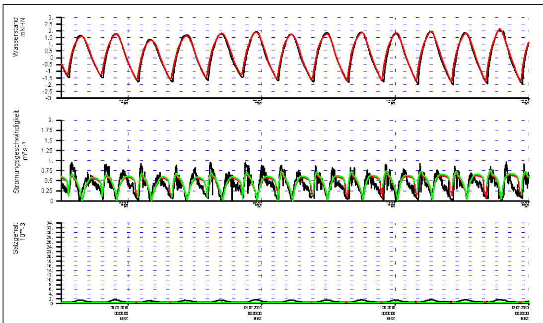
Bild 18: Pegel Papenburg; oben: Zeitreihen des Wasserstandes für die Messung (in Schwarz) und die Simulation (in Rot); Mitte: Zeitreihen der skalaren Strömungsgeschwindigkeit für die Messung (in Schwarz: -0,9 mNHN) und die Simulation (in Rot: -2,5 bis -1,5 mNHN; in Grün: -1,5 bis -0,5 mNHN); unten: Zeitreihen des Salzgehaltes für die Messung (in Schwarz: -4,0 mNHN) und die Simulation (in Rot: -2,5 bis -1,5 mNHN; in Grün: -1,5 bis -0,5 mNHN)
