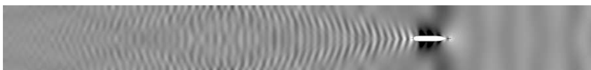
Abb. 6: Wellenbild des Kriso Containerschiffs bei h/T = 1,7 und V = 15 kn
