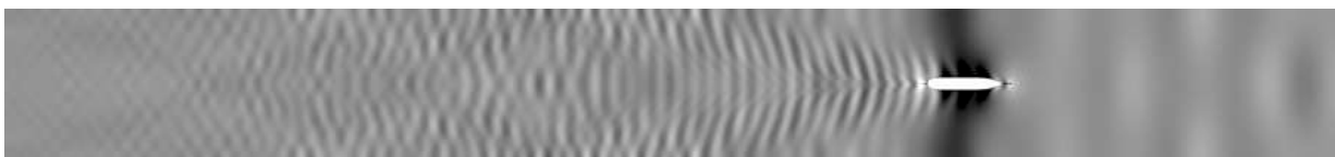
Abb. 4: Wellenbild des Kribo Containerschiffs bei h/T = 1,5 und V = 15 kn
