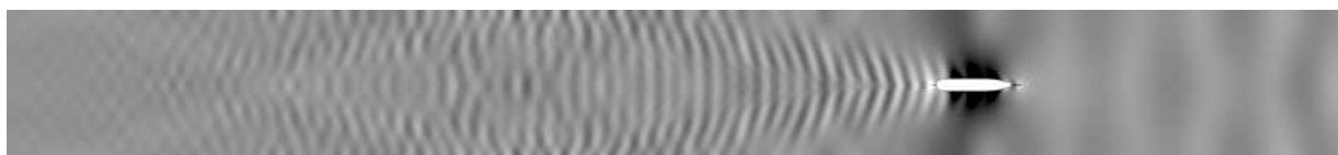
Abb. 5: Wellenbild des Kriso Containerschiffs bei h/T = 1,6 und V = 15 kn
