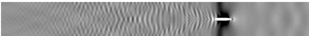
Abb. 3: Wellenbild des Kribo Containerschiffs bei h/T = 1,4 und V = 15 kn
