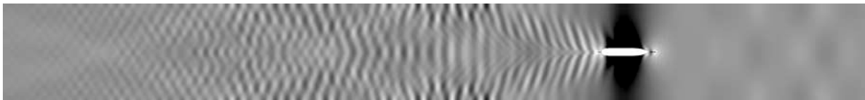
Abb. 2: Wellenbild des Kribo Containerschiffs bei h/T = 1,3 und V = 15 kn
