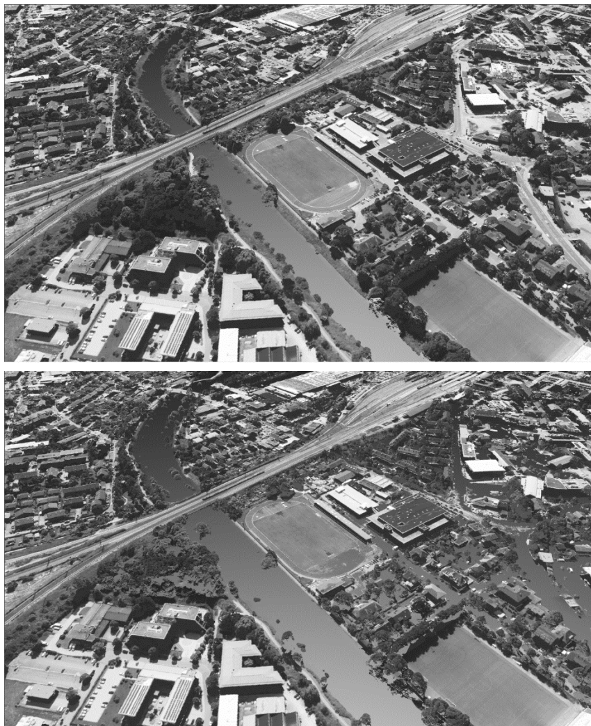
Abbildung 3: Visualisierung zweier HydroAS-2d Modellierungsschritte (hellgrau) an der Mangfall in HydroVISH zusammen mit RGB-eingefärbten DOM zur verbesserten Beurteilung des zeitlichen Verlaufes und der räumlichen Ausbreitung eines HQ100-Ereignisses unten im rechten Bildbereich.
