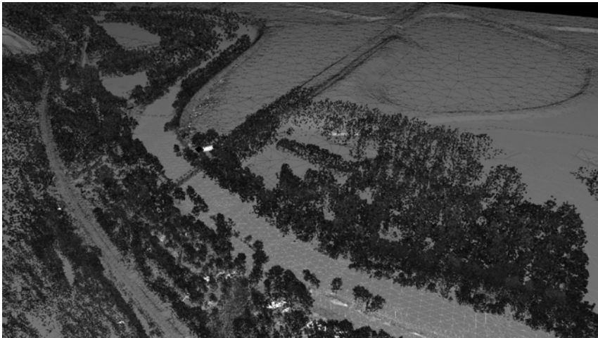
Abbildung 2: Visualisierung HydroAS-2d Modellierungsergebnisse (Dreiecksnetz mit weißen Linien im Flussbereich) an der Mangfall in HydroVISH zusammen mit CFD-Netz (Dreiecksnetz mit schwarzen Linien im hinteren Vorlandbereich) und ALB-Punktwolke (Vegetation).
