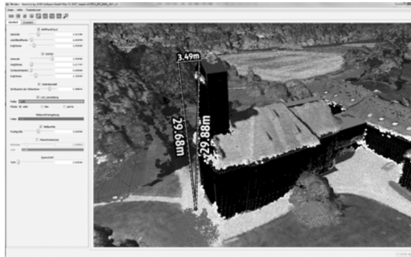
Abbildung 6: Höhenmessung in KomVISH zur Ermittlung von Objekthöhen mit gleichzeitiger Visualisierung von RGB-eingefärbten DOM und LoD2-Gebäudedaten in dunkelgrau.
