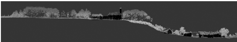
Abbildung 7: Interaktiver Profilschnitt in KomVISH mit gleichzeitiger Visualisierung der Laserpunktwolke eingefärbt nach Höhe (hellgrau bis mittelgrau) und LoD2-Gebäudedaten in dunkelgrau.
