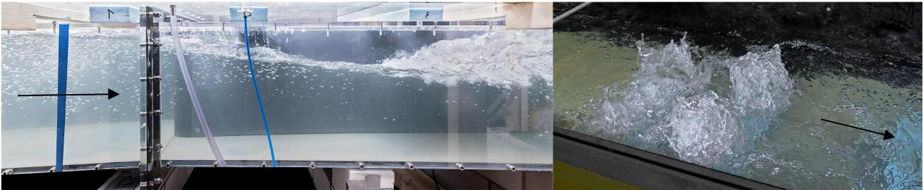
*Bild 5: Wechselsprung in der Aufweitung des Mündungsbauwerks (links) für Dimensionierungsabfluss und mittleren Seespiegel. Im System herrscht Druckabfluss. Als Maßnahme werden Einbauten in Kombination mit einer Perforation der Decke angeordnet, um den Wechselsprung zu verhindern. Die Luft entgast in Form von Aufwölbungen über die perforierte Decke (rechts).*
