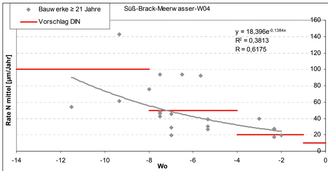
**Abb. 23:** Mittlere Abrostungsraten – Lage der DIN-Werte im Niedrigwasserbereich
