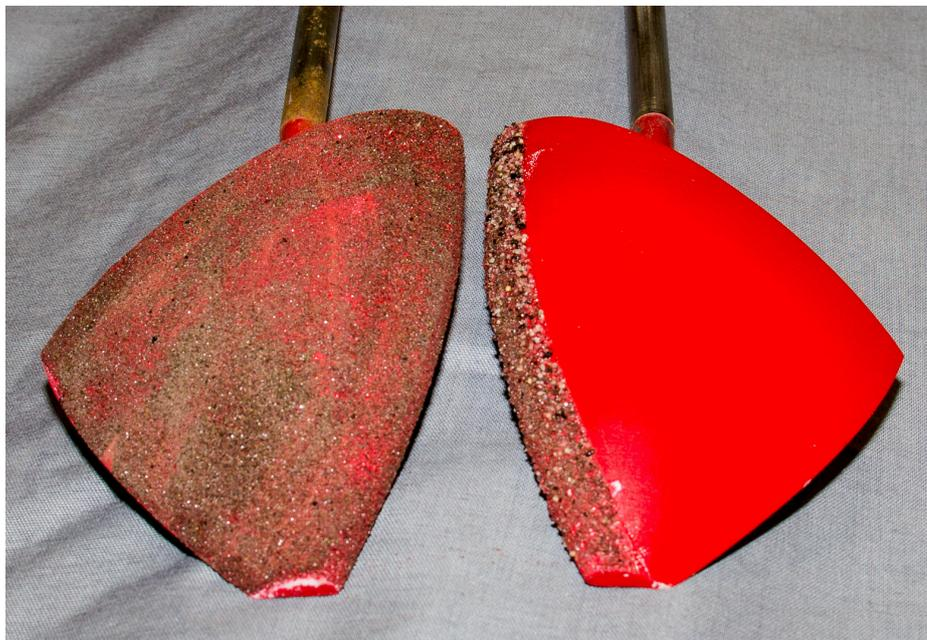
Abb. 5.11: Saugseiten der beiden SKATE-Profile mit verschiedenen Turbulenzerzeugern.
