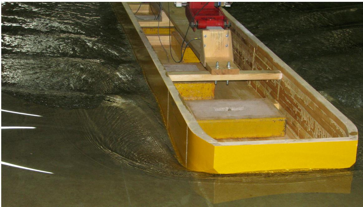
Abb. 5.9: Geradeausfahrt an der PMM-Anlage
