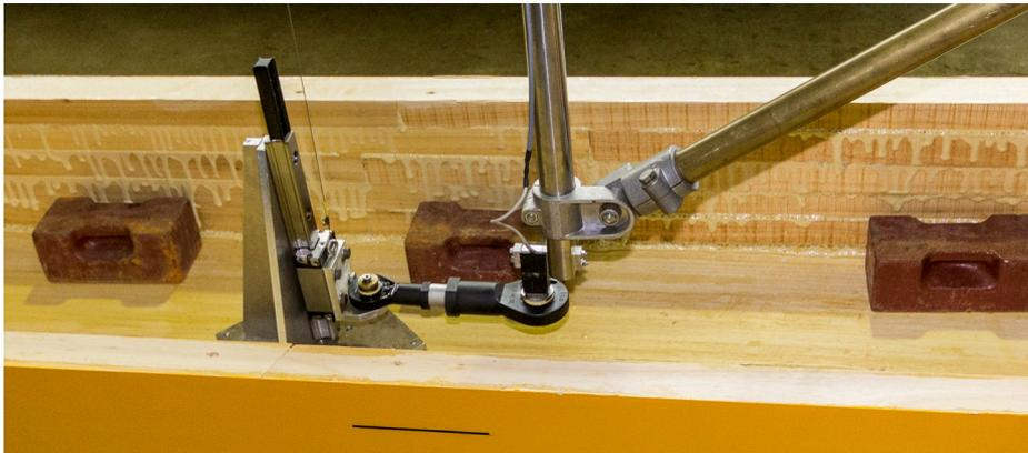
Abb. 5.3: Anordnung der Präzisionswägezelle als Widerstands-Dynamometer.
