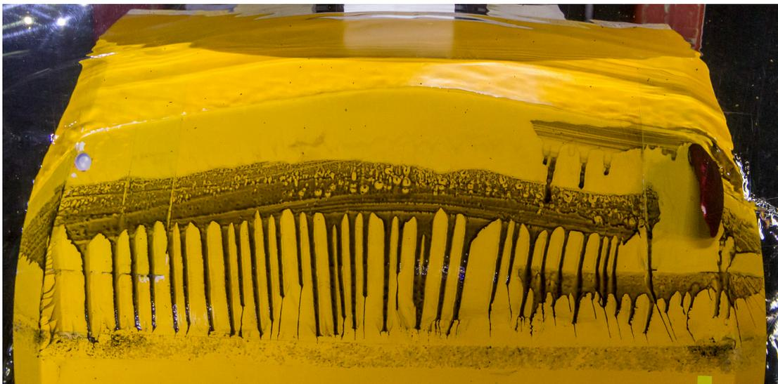
Abb. 5.7: Verlaufene Ölfarbe nach dem Farbanstrichversuch.
