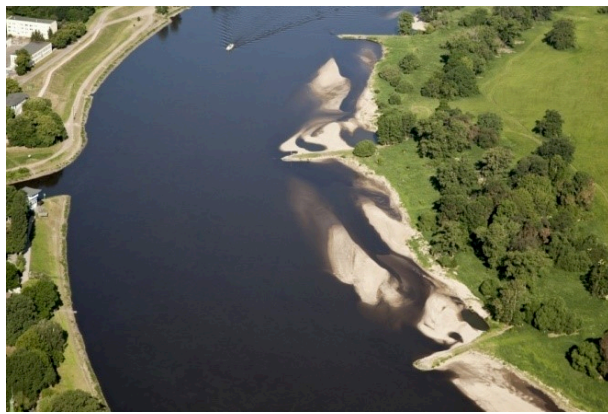
Bild 4: links: Strukturvielfalt in Bühnenfeldern an der Donau (Stolz i.A. des WWA Deggendorf) rechts: Rinnenstrukturen in Bühnenfeldern an der Elbe (A. Hilger i.A. des WSA Dresden)
