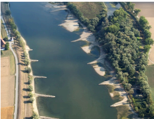
Bild 4: links: Strukturvielfalt in Bühnenfeldern an der Donau (Stolz i.A. des WWA Deggendorf) rechts: Rinnenstrukturen in Bühnenfeldern an der Elbe (A. Hilger i.A. des WSA Dresden)
