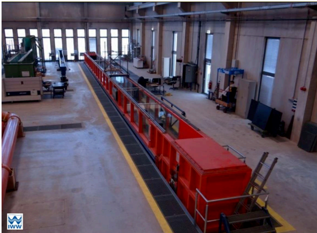
Bild 25: Ansicht der Kipprinne in der Versuchshalle des IWW (nach Oetjen et al. 2017)
