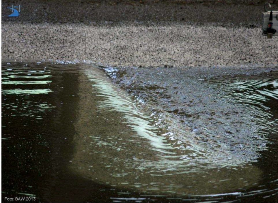
Bild 36: Maximaler, annähernd zweidimensionaler dynamischer Überströmungsprozess einer Strombuhne infolge der schifferzeugten, langperiodischen Primärwelle (3D-Maßstabsmodell 1:40; BAW 2015)
