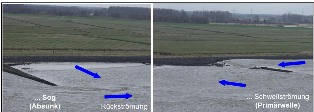
Bild 6: Ablauf der langperiodischen Wellen und Strömungsprozesse in Buhnenfeldern an einer Seeschiffahrtsstraße (BAW 2012a)
