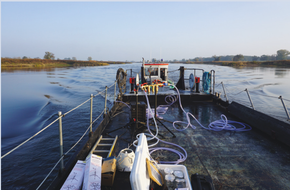
Filterkaskade zur Probennahme für Mikroplastikuntersuchungen an der Elbe © BfG
