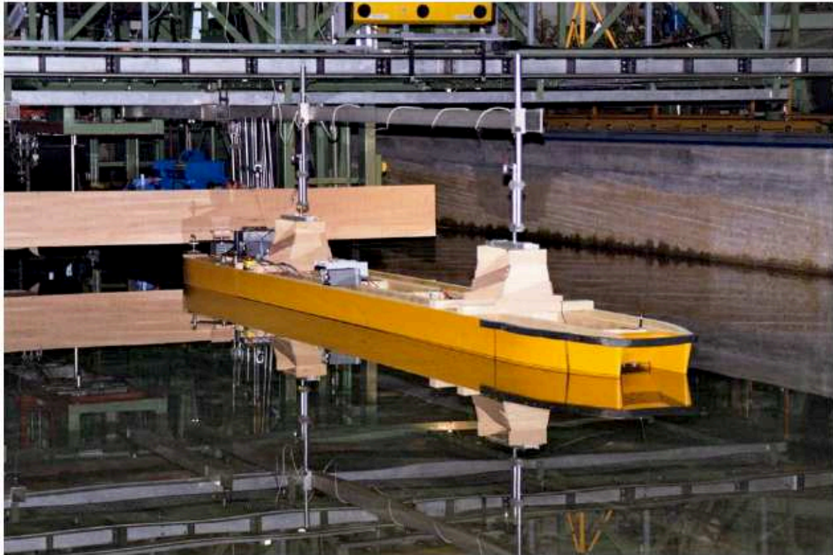
Abb. 74 Modell M1772 vor dem Beginn der Messfahrt; während der Fahrt fährt das Modell frei.
