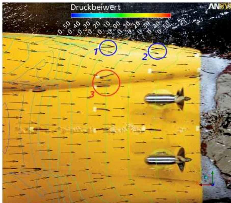
Abb. 23 Vergleich Stromfadenversuch mit numerischen Ergebnissen für M1772
