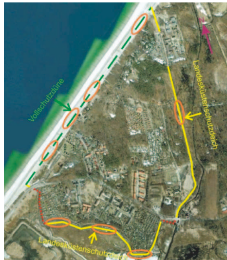
Abbildung 17: Versagenslokationen entlang der Hochwasserschutzanlagen.
