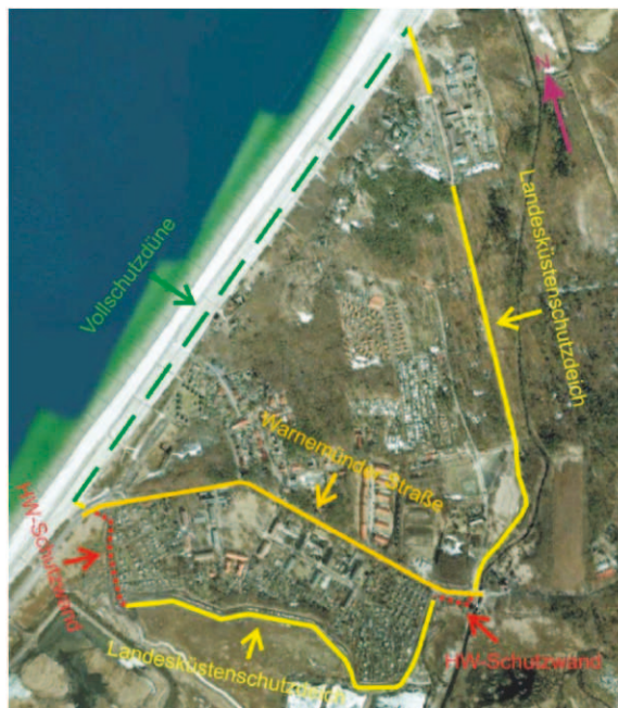
Abbildung 16: Hochwasserschutzanlagen um Markgrafeneide.
