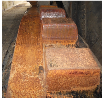
Abbildung 2: Links: Historischer Verschluss Viereth (Quelle: WNA Aschaffenburg); Rechts: Zahnkranz mit plastischen Verformungen (Quelle: IRS AG)
