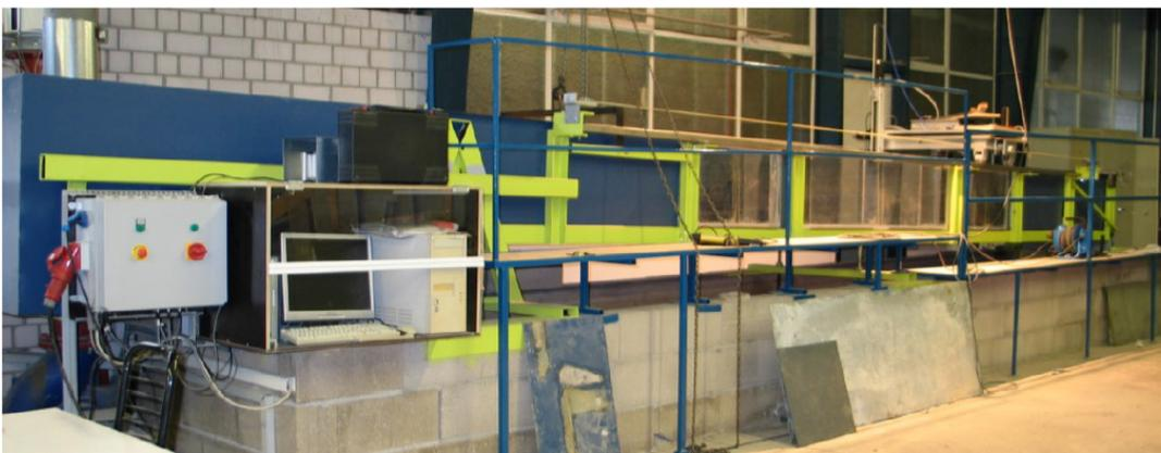
Bild 1: Schlitzpass-Versuchsstand mit sechs Becken am IWG (Belz et al. 2013)
