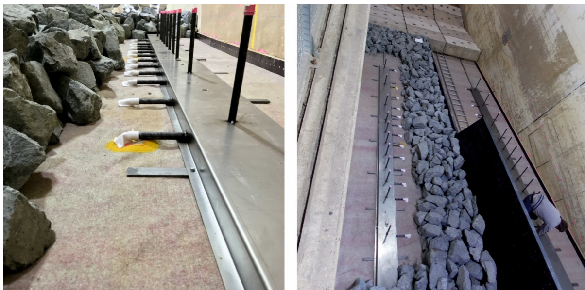
Abbildung 13: Druckmessdosenkanal in der Deckschicht (Fotos: Kreyenschulte 2017).
