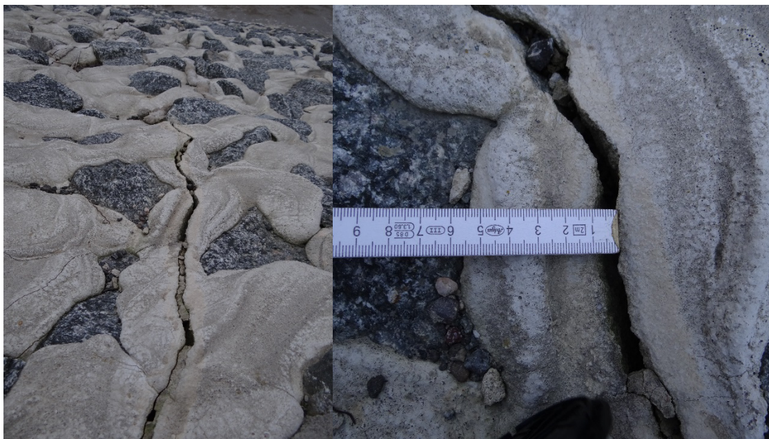
Abbildung 4: Risse des Typs 3 (Fotos: Kreyenschulte 2015).
