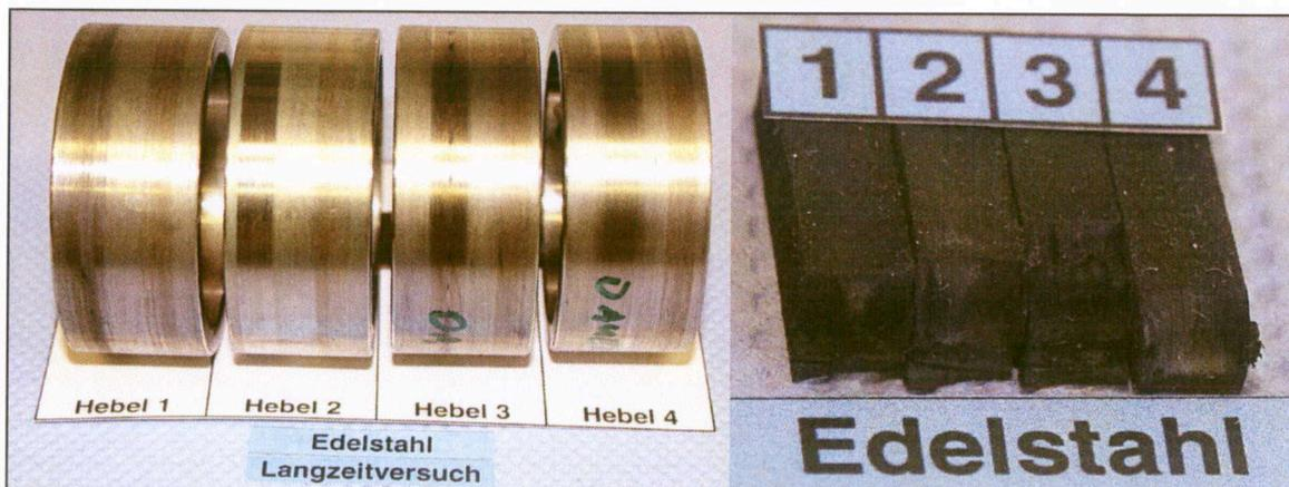
**Bild A25:** Edelstahl-Ringe und Prüfpins nach 96 h Prüfzeit
