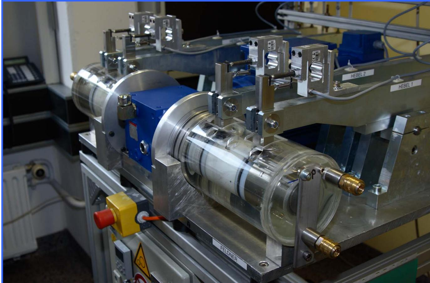
Festgelegte Prüfparameter:  $p = 8 \text{ MPa}$ ,  $v = 0.05 \text{ m/s}$ ,  $t = 504 \text{ h}$
