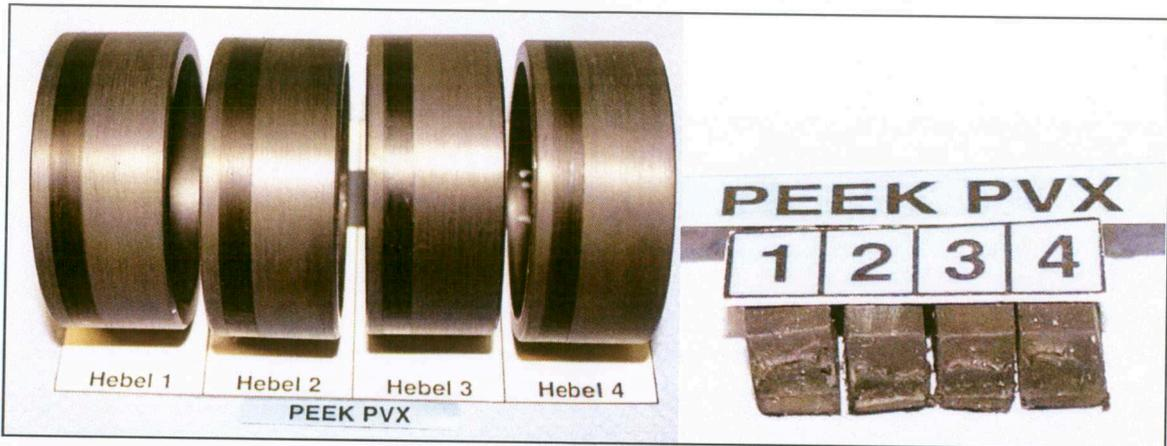
Bild A19: PEEK PVX-Ringe und Prüfpins nach 20 h Prüfzeit
